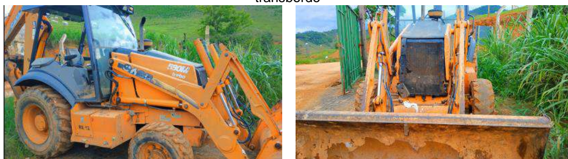
Figura 89: Retroescavadeira utilizada para manejo de resíduos sólidos domiciliares no transbordo
